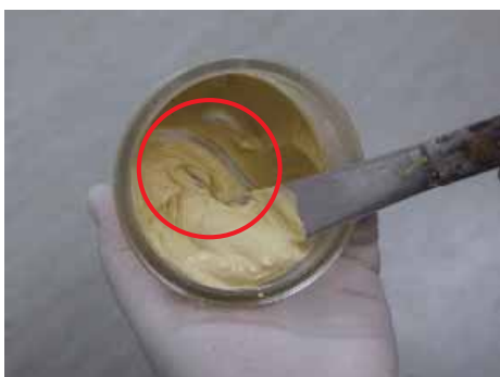
混水量は適正だが、底部を手練和でなじませ不足 (自動攪拌前)
